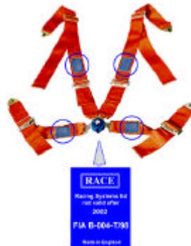
\* Se recuerda que todas las etiquetas de homologación excepto una, pueden ser reemplazadas por etiquetas de identificación.
