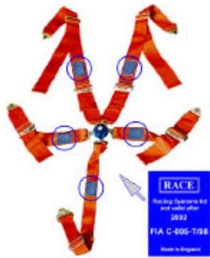
\* Se recuerda que todas las etiquetas de homologación excepto una, pueden ser reemplazadas por etiquetas de identificación.
